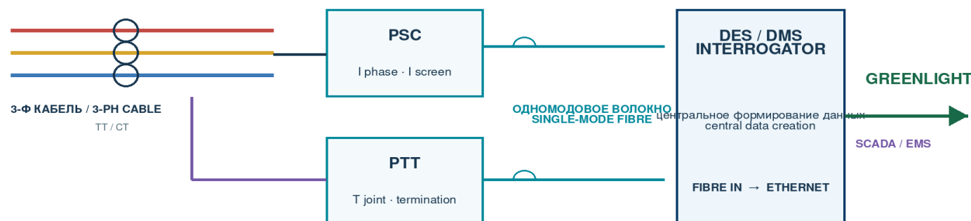
ИЗМЕРИТЕЛЬНЫЙ ТРАКТ GREENLIGHT / GREENLIGHT MEASUREMENT CHAIN
